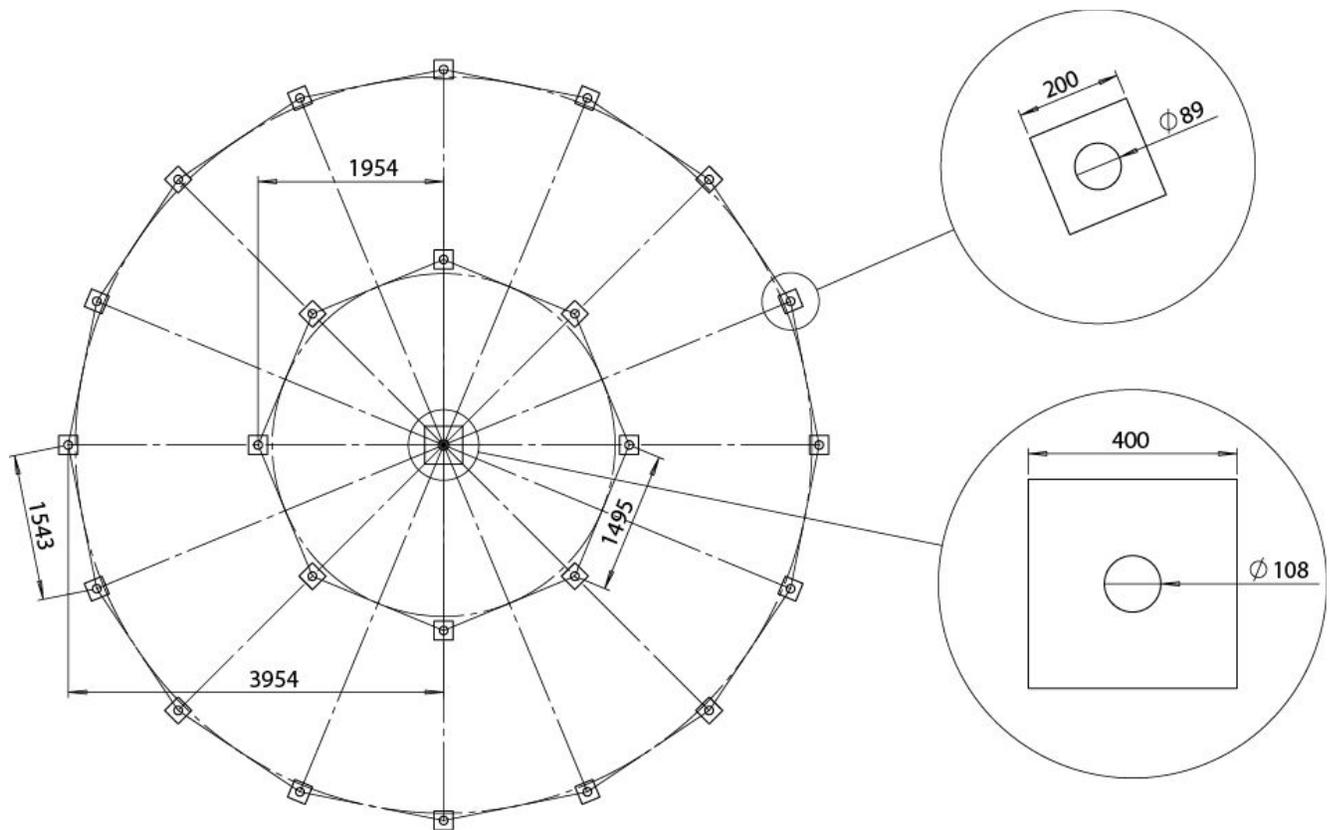
Возможно применение ленточного или монолитного фундамента; комбинирование свай по периметру и бетонной опоры в центре; иные виды фундамента.
