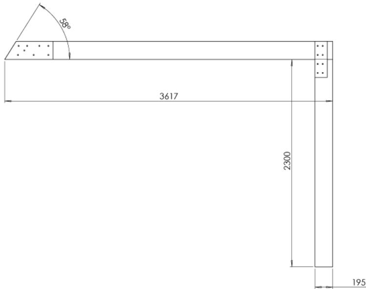
Опоры лаг пола и сами лаги пола второго этажа - это обыкновенные доски хвойных пород.
