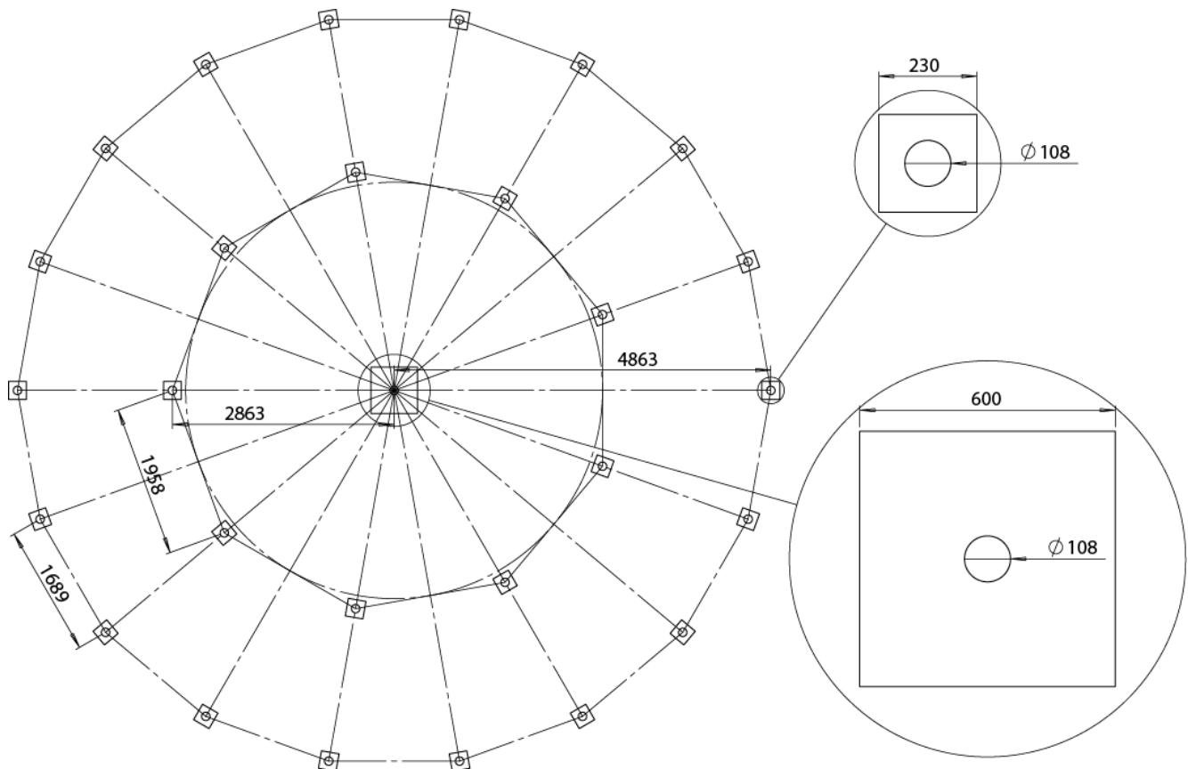
Возможно применение ленточного или монолитного фундамента; комбинирование свай по периметру и бетонной опоры в центре; иные виды фундаментов.
