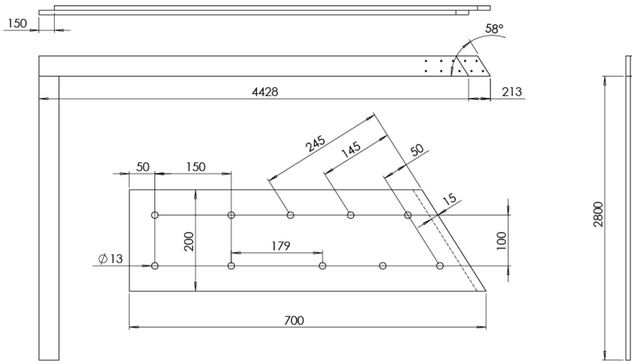
Опоры лаг пола и сами лаги пола второго этажа - это обычновенные доски хвойных пород. Крепежные накладки делаются из ФСФ фанеры толщиной 30 мм. Рекомендуем оставлять достаточный второй свет для организации лестницы и максимальной эстетики конструкции.
