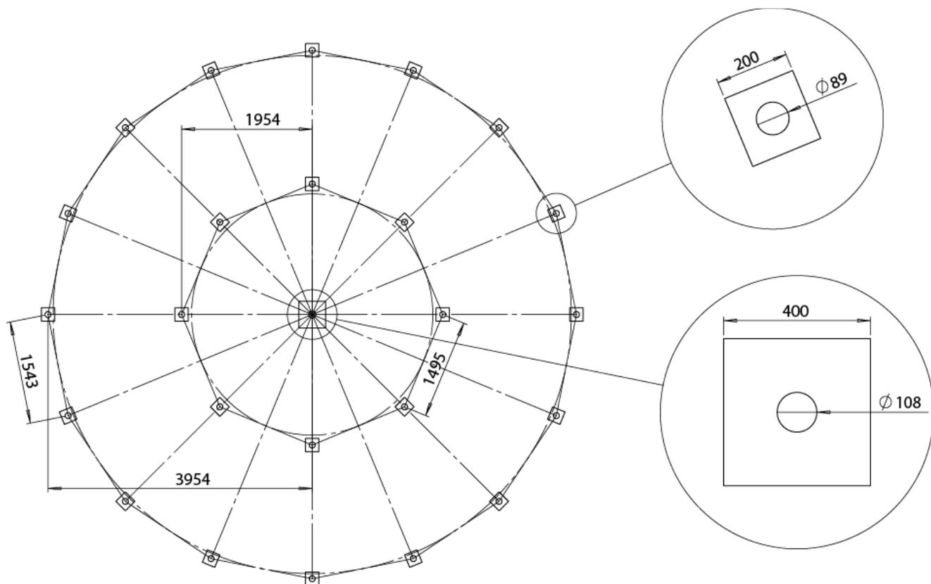
Возможно применение ленточного или монолитного фундамента; комбинирование свай по периметру и бетонной опоры в центре; иные виды фундамента.
