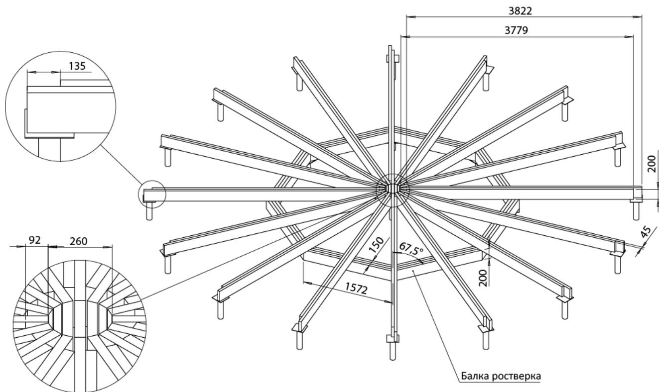
Лаги пола и балки ростверка в комплект поставки не входят, изготавливаются на месте из сухого пиломатериала.
