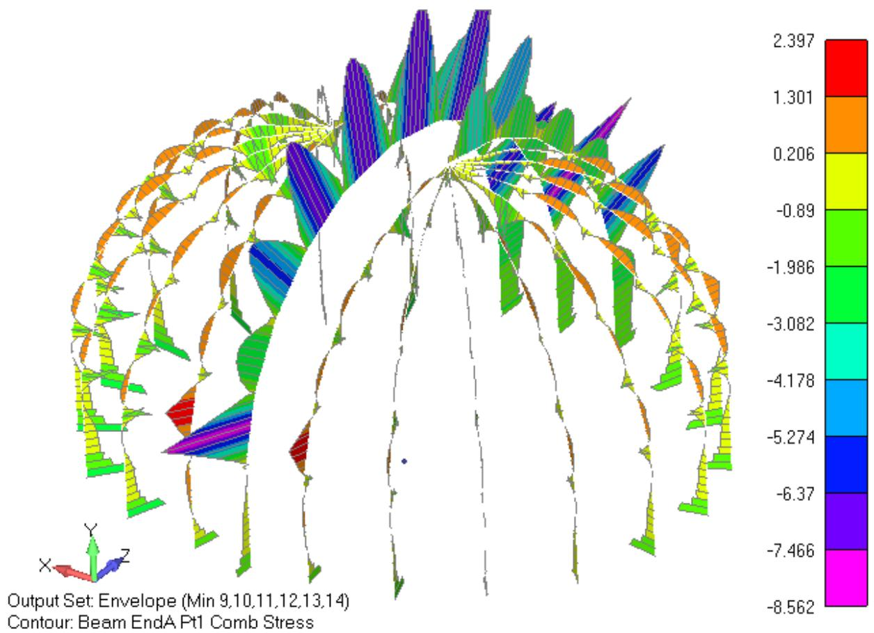
Рисунок 32. Огибающая минимальных напряжений в балках, МПа. Основные сочетания
