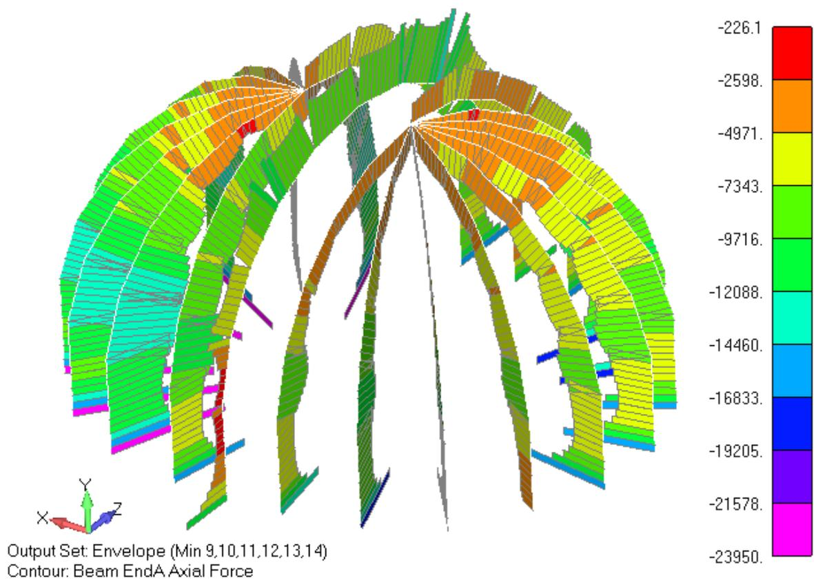
Рисунок 26. Огибающая минимальных осевых сил в балках, Н. Основные сочетания
