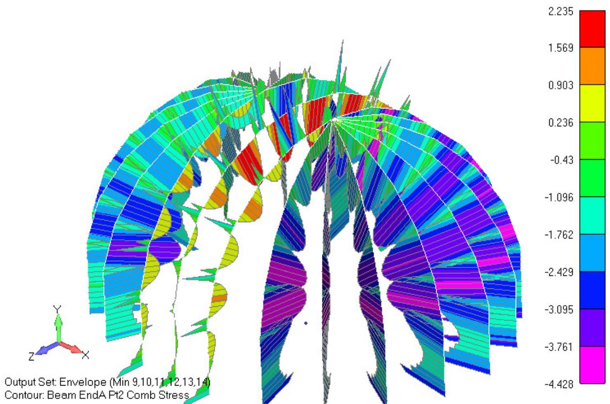
Рисунок 18. Огибающая минимальных напряжений в балках в верхней и нижней точка сечения, МПа. Основные сочетания
