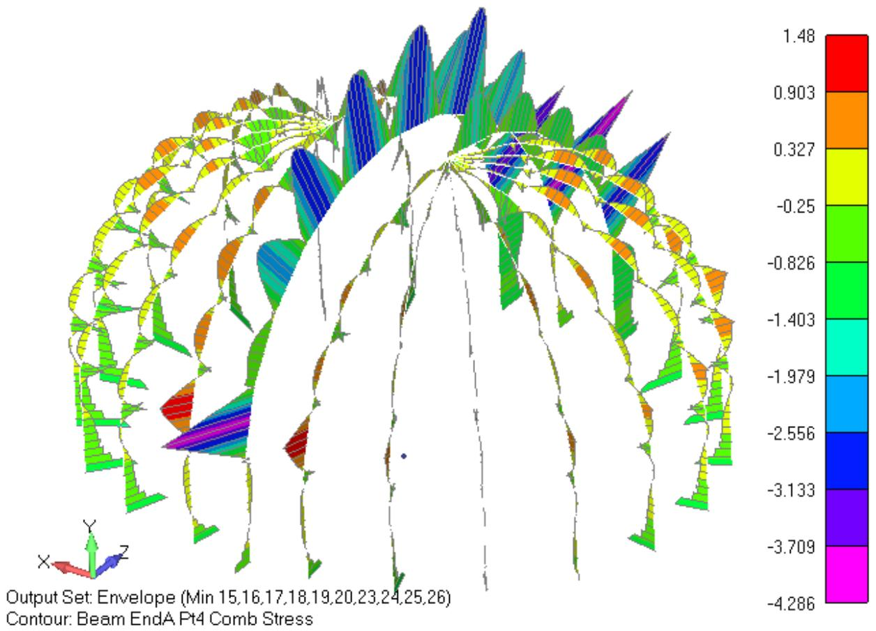
Рисунок 34. Огибающая минимальных напряжений в балках, МПа. Особые сочетания
