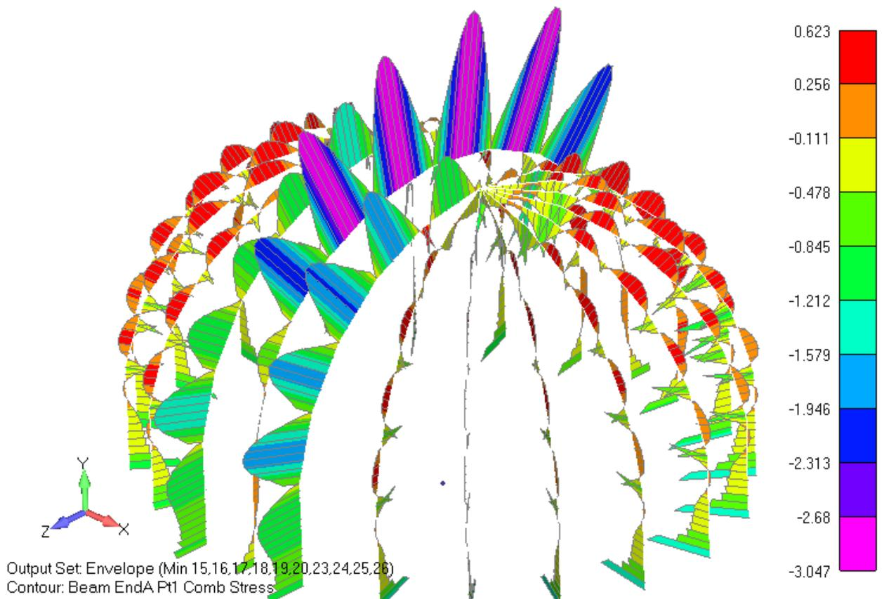
Рисунок 20. Огибающая минимальных напряжений в балках, МПа. Особые сочетания
